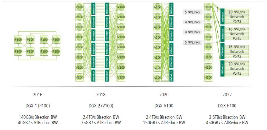
圖 8：V100 後之 GPU 可透過 NVSwitch 實現多節點間的連線
