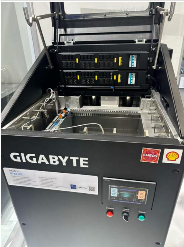
圖 42: 技嘉展示浸沒式冷卻液槽
