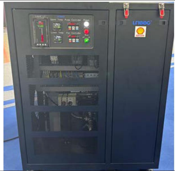
圖 56: 晟銘電單相浸沒式液冷產品
