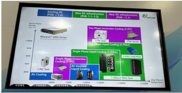
圖 34: 緯穎解決方案的伺服器功率密度與晶片熱功耗設計矩陣
