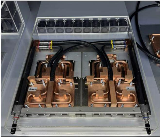
圖 47:台達電提供 GB200 水冷板以及散熱風扇解決方案
