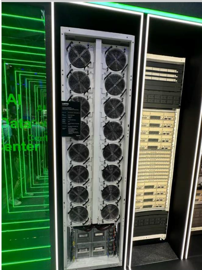
圖 24: 鴻佰 side car 解決方案 (正面)
