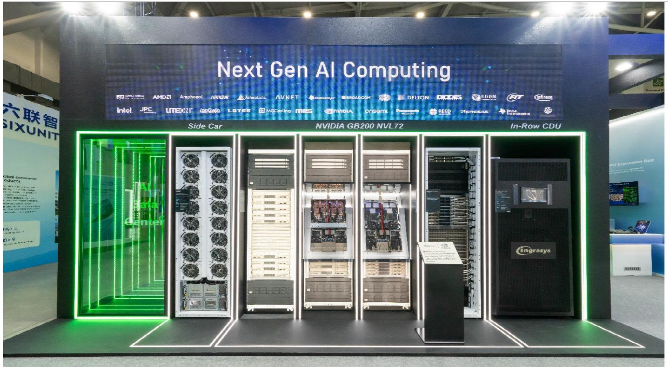
圖 21: 鴻佰展區展示完整的 GB200NVL36/72 之 AI 伺服器機櫃，並採用直接液冷 (DLC) 解決方案
