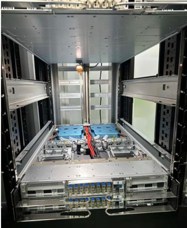
圖 28: 緯穎的 2-PDLC (雙相液冷) 水冷板
