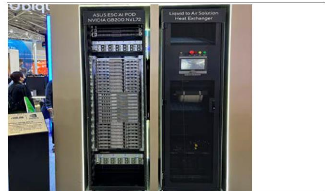
圖 60: ASUS ESC AI POD 採用 NVIDIA GB200 NVL72 架構，機櫃旁搭配展示 sidecar
