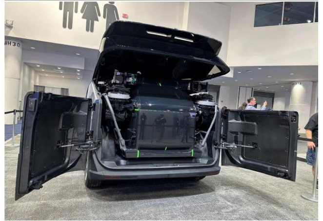
圖 31: 「小鵬匯天」的空中模組存放在地面模組的後車艙內
